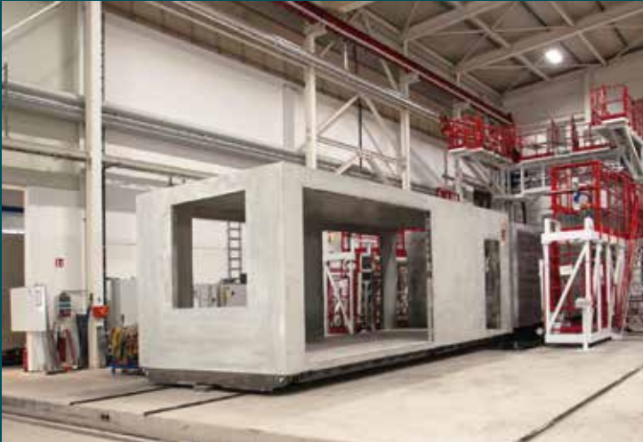
Das Rohmodul wird zurück in die Horizontale gebracht und aus der Schalung verfahren.
