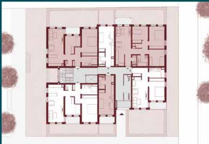
Beispielhaftes Regelgeschoss mit 1-, 2- und 3-Zimmerwohnungen
